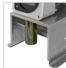
Dispositivo selado para a coleta de poeira tóxica
