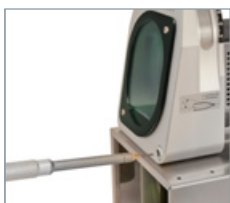
Präzise Längenjustierung der Elektrode.
