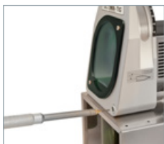
Präzise Längenjustierung der Elektrode.
