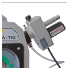
Modulo de afilado - rotación automática de lo soporte de electrodo
