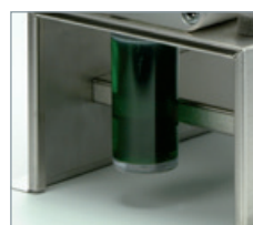
Lukket returbeholder til støvsamling og videre deponering
