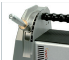
Slibevinkler fra 7,5-90° skaber spidsvinkler fra 15-180°
