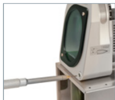
Præcis længdebestemmelse af elektrodens stick-out
