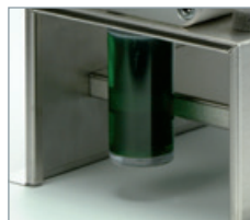
Lukket returbeholder til støvopsamling og videre deponering
