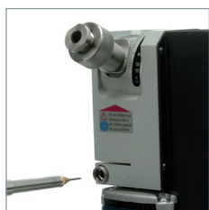
Ajuste preciso en lo stick-out
