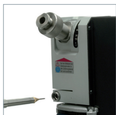
Réglage précis de la longueur de l'électrode.
