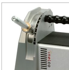
Afila el electrodo en el ángulo deseado
