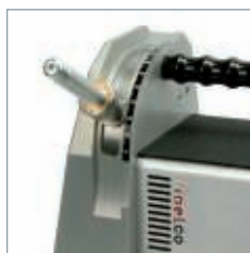
Schleifen der Elektrode im gewünschten Winkel.
