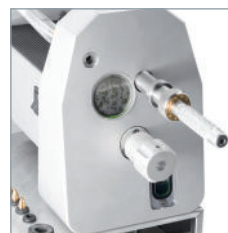
Den Handgriff drehen, um die Elektrode zu kürzen.
