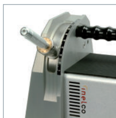
Schleifen der Elektrode im gewünschten Winkel.
