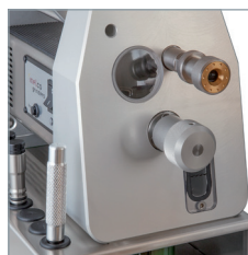
Drej håndtaget for at afkorte elektroden
