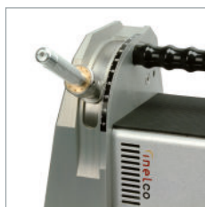
Afila el electrodo en el ángulo deseado
