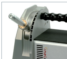
Slibevinkler fra 7,5-90° skaber spidsvinkler fra 15-180°
