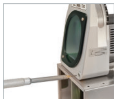
Ajuste preciso de electrodo en el stick-out
