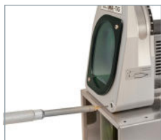
Ajuste de eletrodo com precisão.
