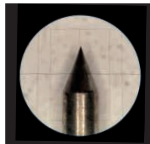
Angle d'affûtage de 45 degrés
