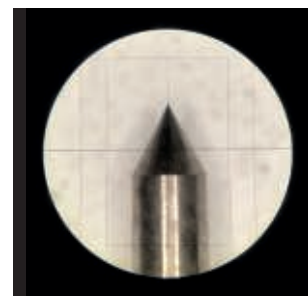
Angle d'affûtage de 60 degrés
