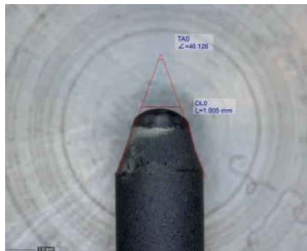
Pointe d'électrode avec forme optimale pour soudage AC
