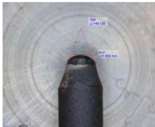
optimal ausgebildetes Elektrodenende unter Wechselstrombelastung
