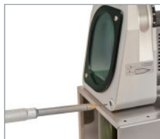
Præcis længdebestemmelse af elektrodens stick-out
