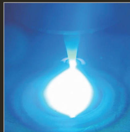
Elektrode med 15° slibning
